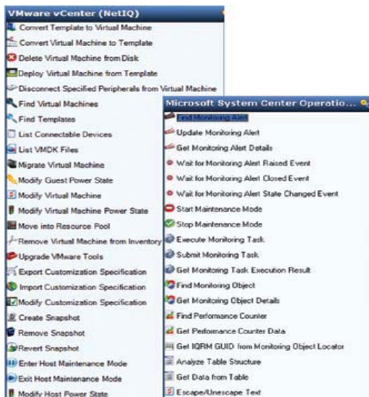
Alle Adapter werden mit einer umfangreichen Activity-Bibliothek ausgeliefert, in der sich die Drag&Drop-Bausteine zur Erstellung von Workflows im Process Designer befinden.
